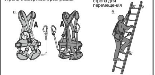
Рис. 5. Краткая пиктографическая информация по использованию карабинов, входящих в комплектацию стропов.
