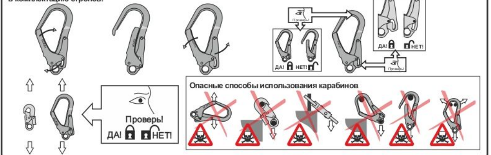
Рис. 6. Способы крепления стропов к анкерным устройствам
