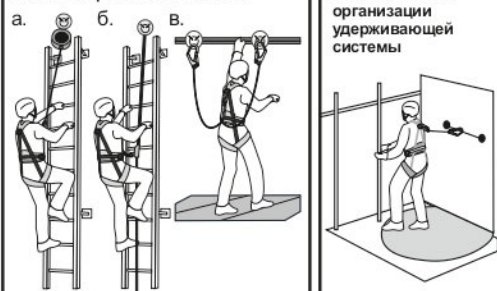
Рис. 13. Пример организации системы канатного доступа
