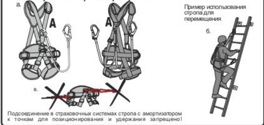
Рис. 6. Использование карбинов, входящих в состав стропов
